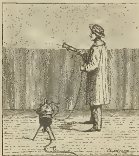
Fig. 2. — Máquina Hook para pintar; modelo «Rapide»
